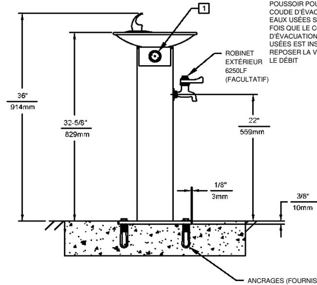
RETIRER LA VALVE DU BOUTON-POUSOIR POUR INSTALLER LE COUDE D'ÉVACUATION DES EAUX USÉES SUR LA CUVE. UNE FOIS QUE LE COUDE D'ÉVACUATION DES EAUX USÉES EST INSTALLÉ, REPOSER LA VALVE ET RÉGLER LE DÉBIT
