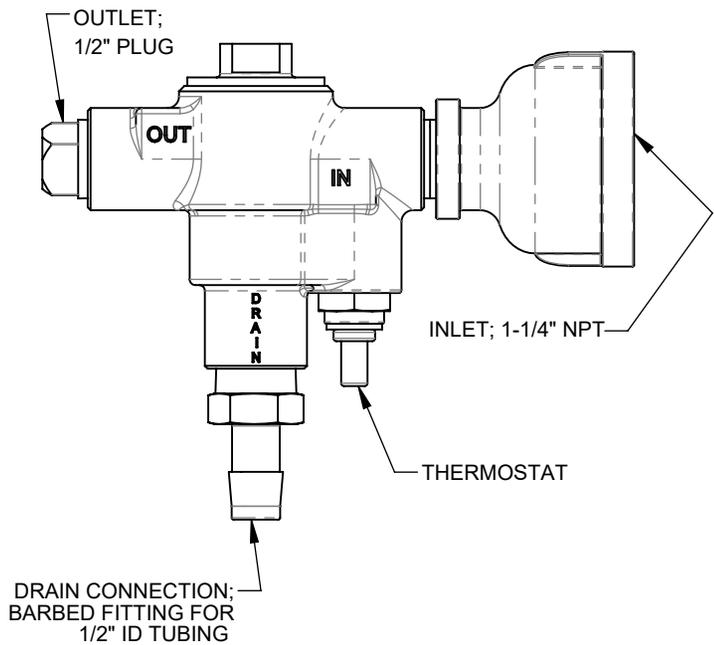
**FACTORY-ASSEMBLED VALVE SECTION**
