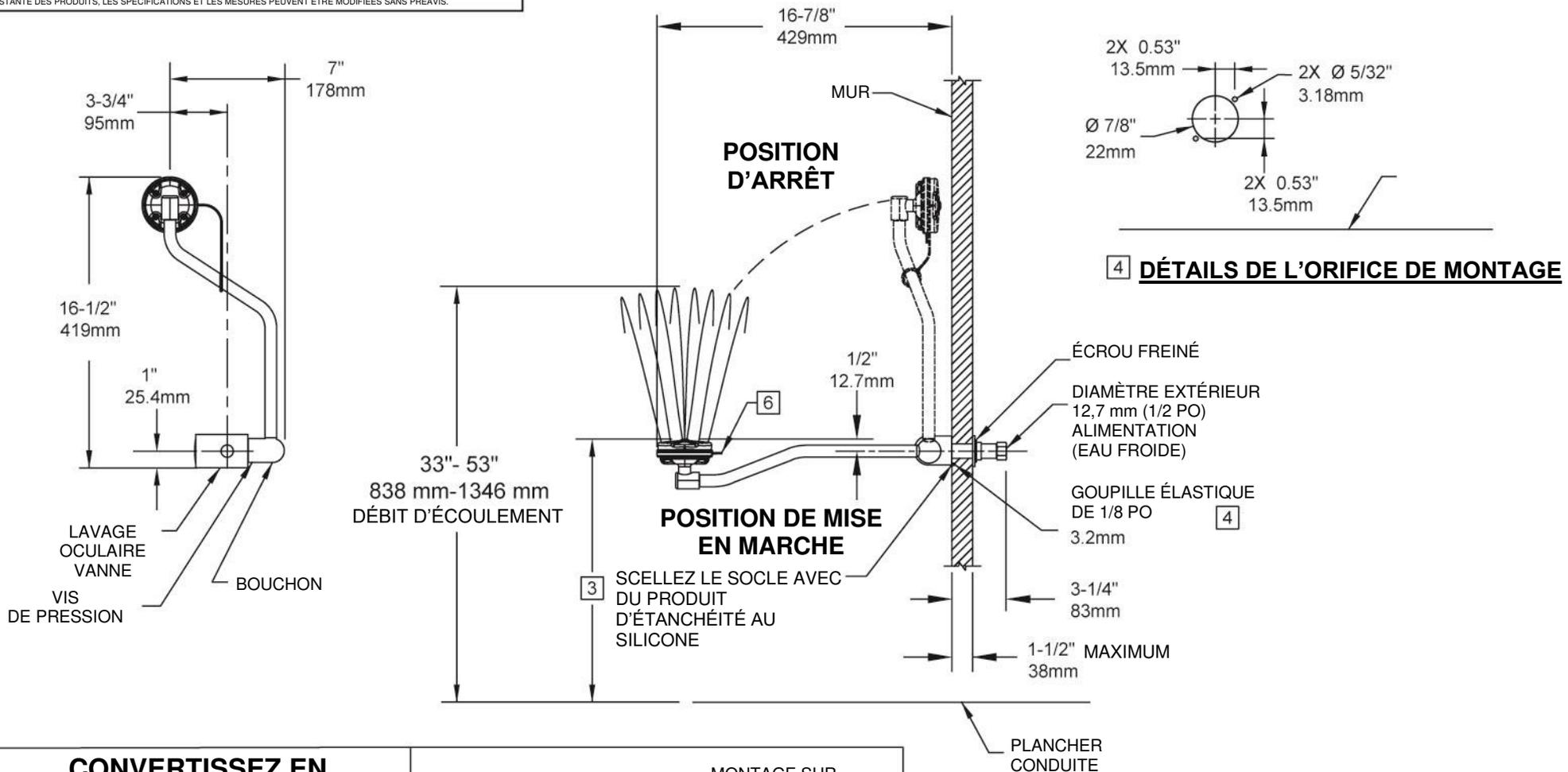
**4 DÉTAILS DE L'ORIFICE DE MONTAGE**
