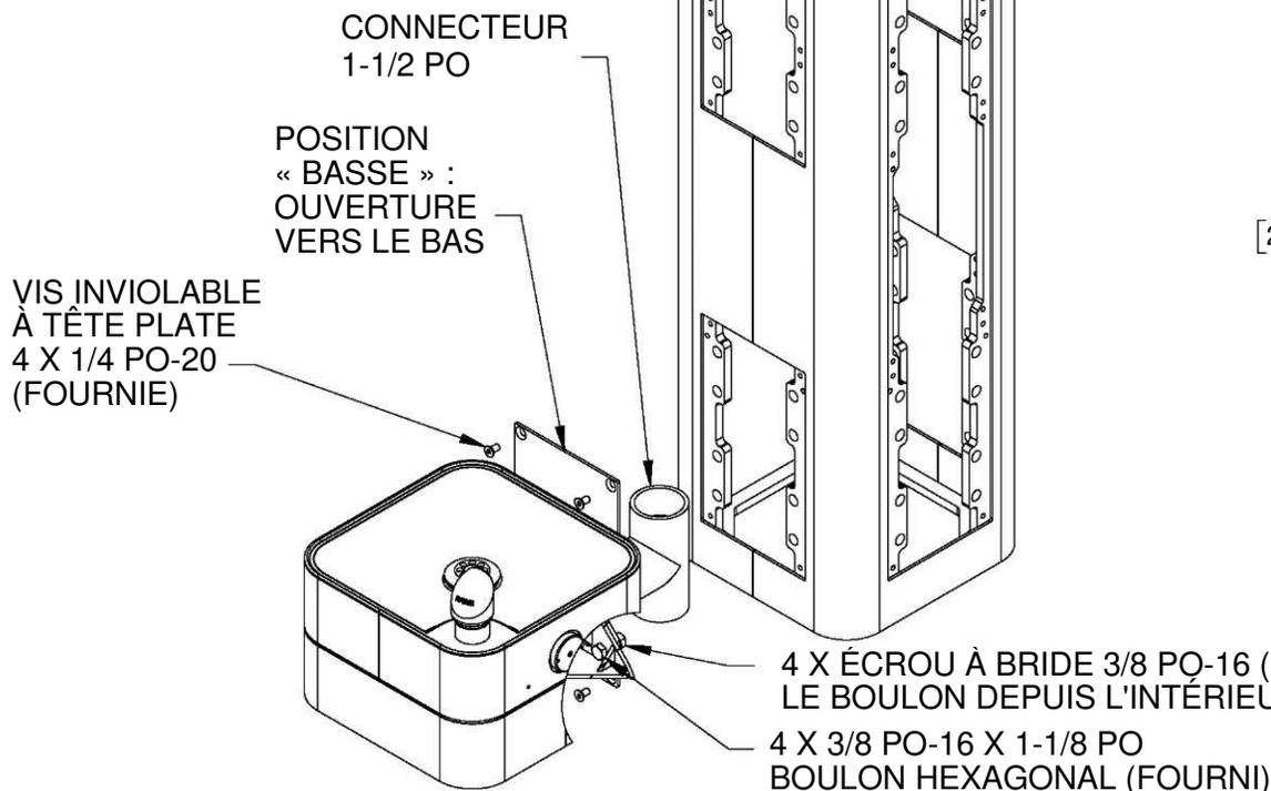
REMARQUE : LA CONFIGURATION STANDARD DU MODÈLE 3670 SUR UN SOCLE EST ILLUSTRÉE. IL EST RECOMMANDÉ DE PLACER L'ENSEMBLE À L'OUVERTURE LA PLUS BASSE DU SOCLE. LA PLAQUE DE MONTAGE PEUT ÊTRE Tournée POUR QUE LA VASQUE DE CHIEN PUISSE ÊTRE EN POSITION « HAUTE » OU « BASSE ». IL EST RECOMMANDÉ D'UTILISER LA POSITION « BASSE ». COMME INDIQUÉ.
